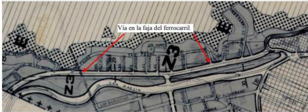
Figura 30. Imagen del ensanche y apertura de vía en faja del ferrocarril, PRC Vigente
