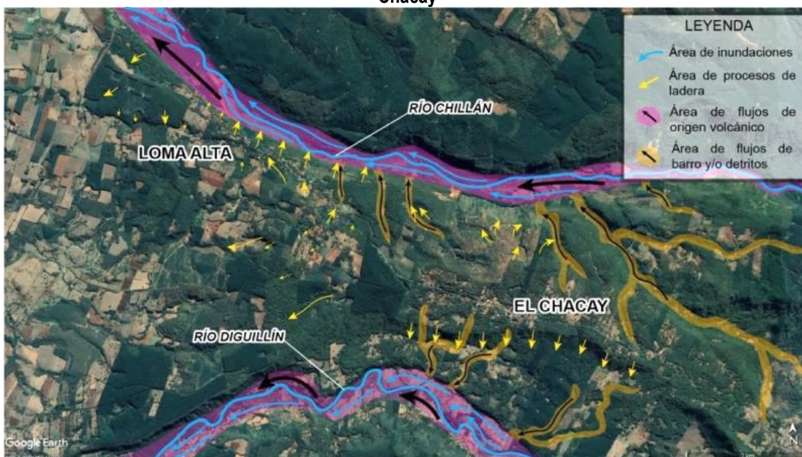
FIGURA N° 9-33: Representación esquemática de los peligros preliminares, Sector Transición: Loma Alta y El Chacay
