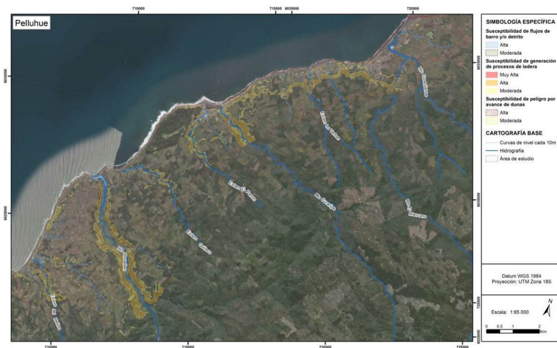
Figura 12 Susceptibilidad de riesgos por flujo de barro y/o detritos, generación de procesos de laderas y avance de dunas, Pelluhue- Curanipe
