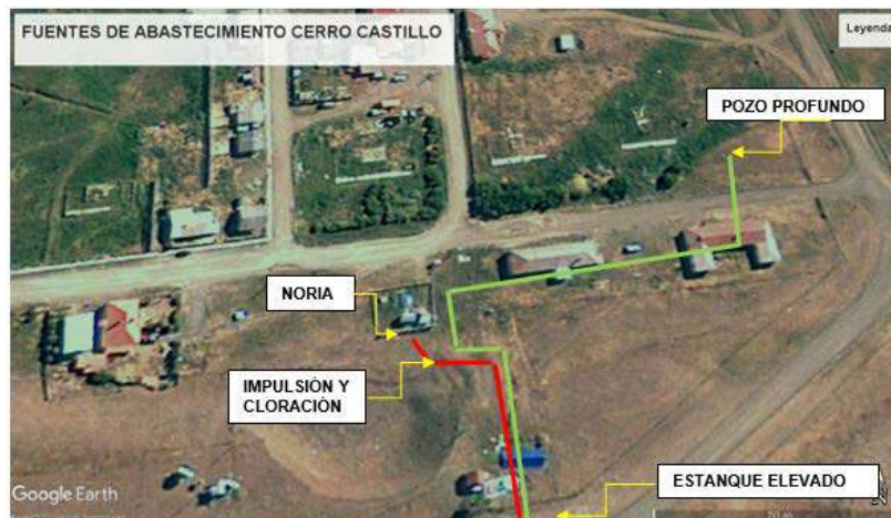
Figura 31. Sistema de Agua Potable Rural (APR) en Villa Cerro Castillo
