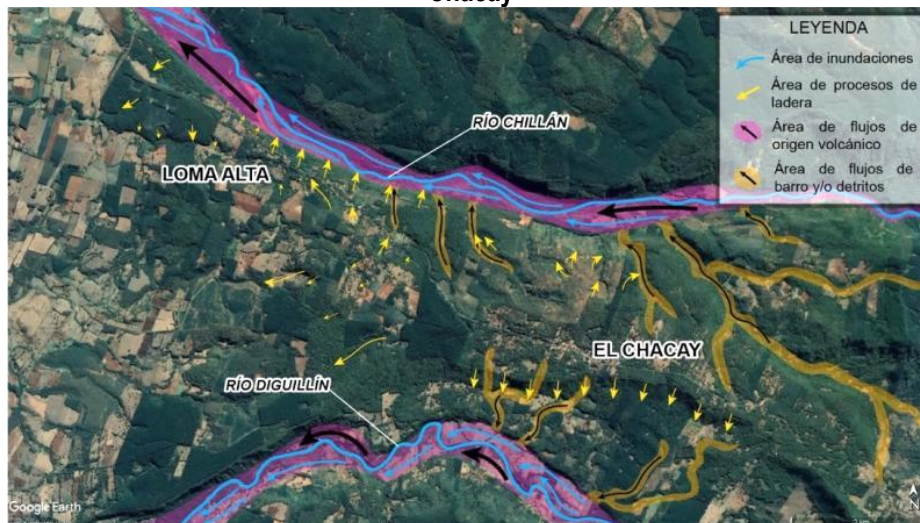
FIGURA N° 9-31: Representación esquemática de los peligros preliminares, Sector Transición: Loma Alta y El Chacay
