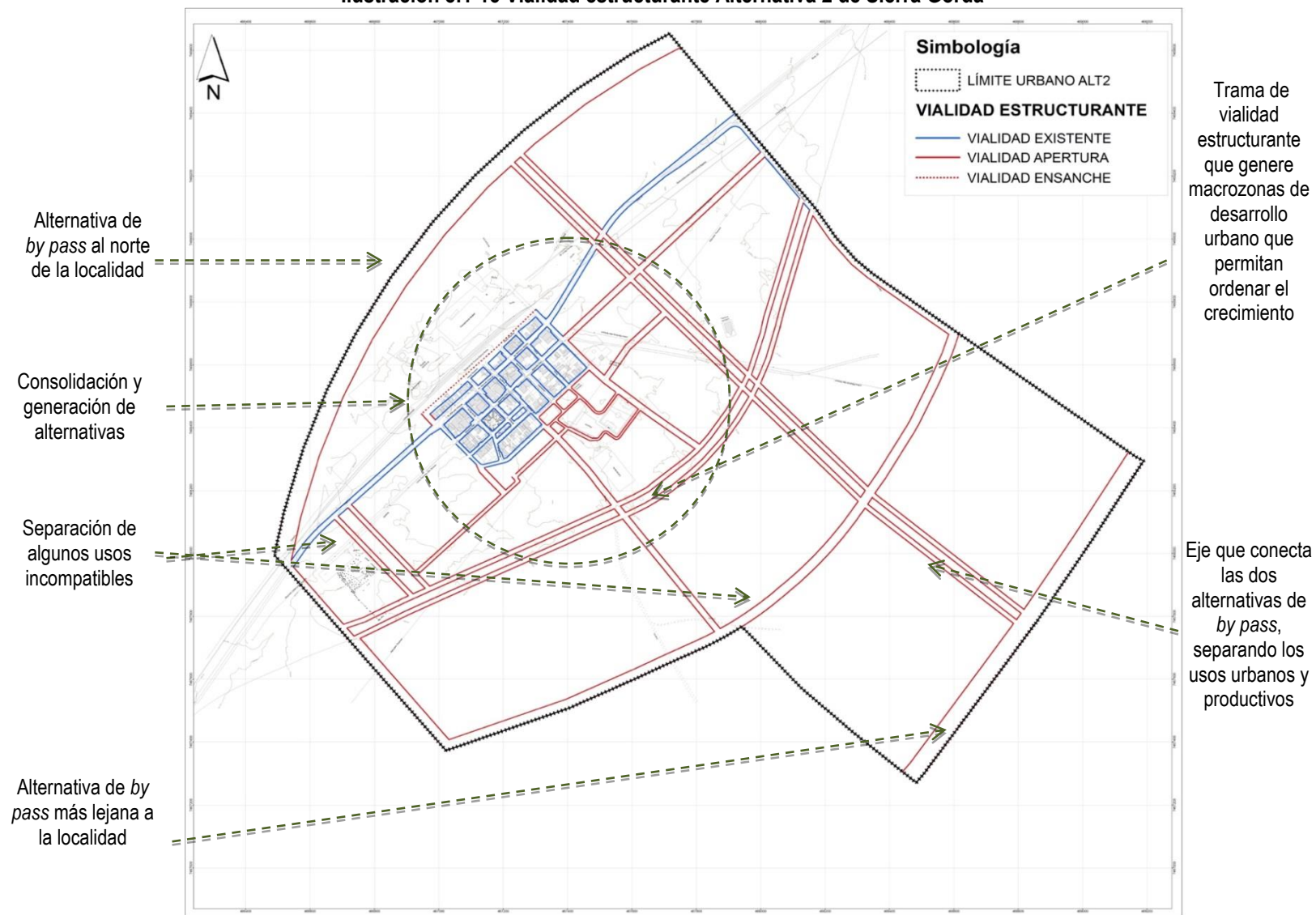
Ilustración 8.1-15 Vialidad estructurante Alternativa 2 de Sierra Gorda
