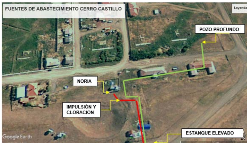
Figura 28. Sistema de Agua Potable Rural (APR) en Villa Cerro Castillo
