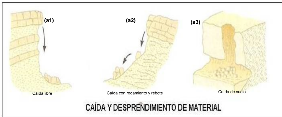
Figura 20 Remociones en Masa de tipo Caídas de Rocas
