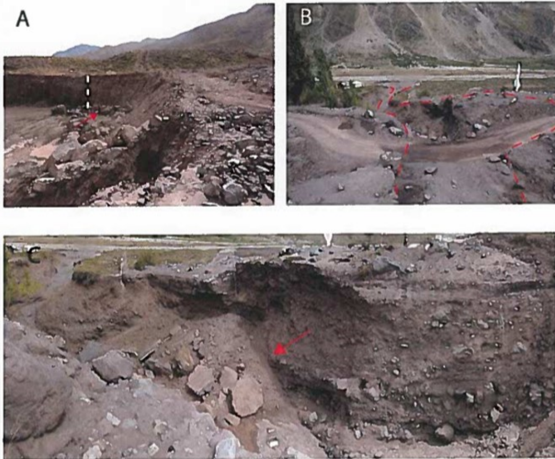
Figura 9. Fotografías de la quebrada ubicada al este del retén de Carabineros. A. Zona del camping de las termas, donde la quebrada perdió confinamiento. Se observa más de 5m de depósitos aluviales antiguos. B. Ruta I-45 donde el aluvión atrapó a la víctima fatal. Se encierra la zona por donde pasó y/o depositó el flujo de detritos. C. Detalle de la zona erosionada por el paso del flujo de detritos. Se indica un cono de deyección que está sobre el depósito de este aluvión que incluye partes del radier erosionado.
