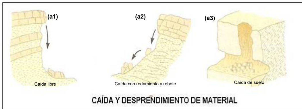
Figura n° 11: Remociones en Masa de tipo Caídas de Rocas
