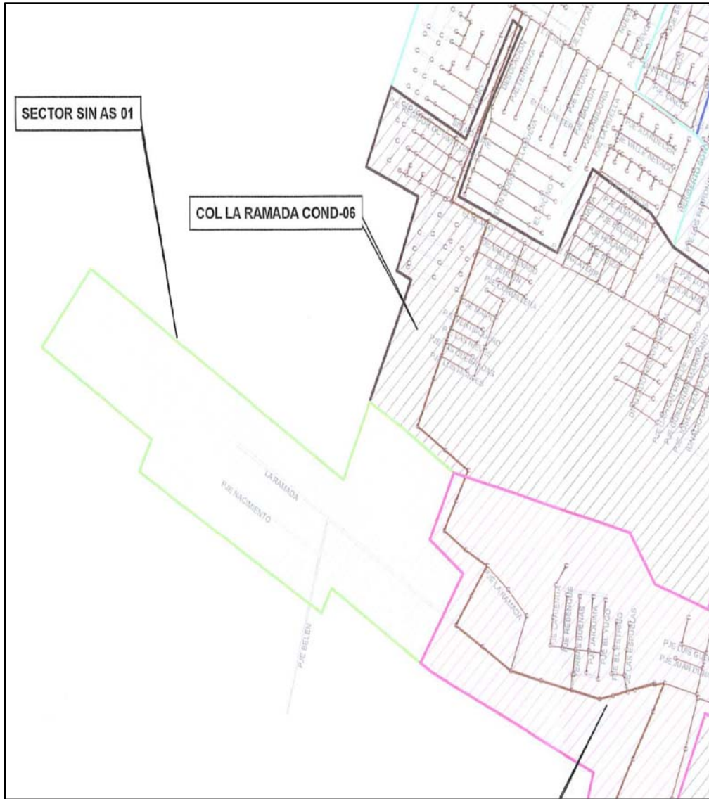
Figura 10.a Detalle de Área 1 sin Cobertura de Alcantarillado en San Fernando.
