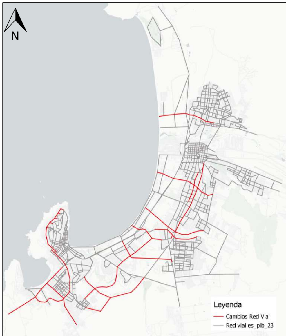
Figura 26 Modificaciones incorporadas a la red vial actual para el escenario tendencial en el año horizonte. Fuente: elaboración propia
