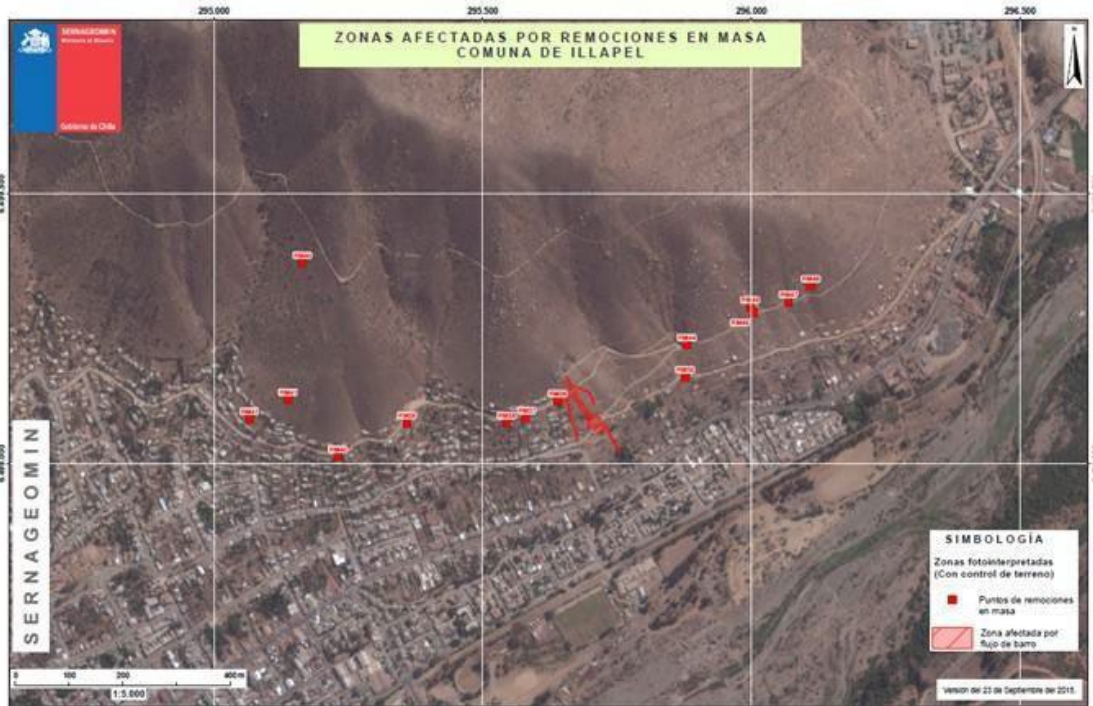
Figura 33- Zonas afectadas por remociones en masa comuna de Illapel.
