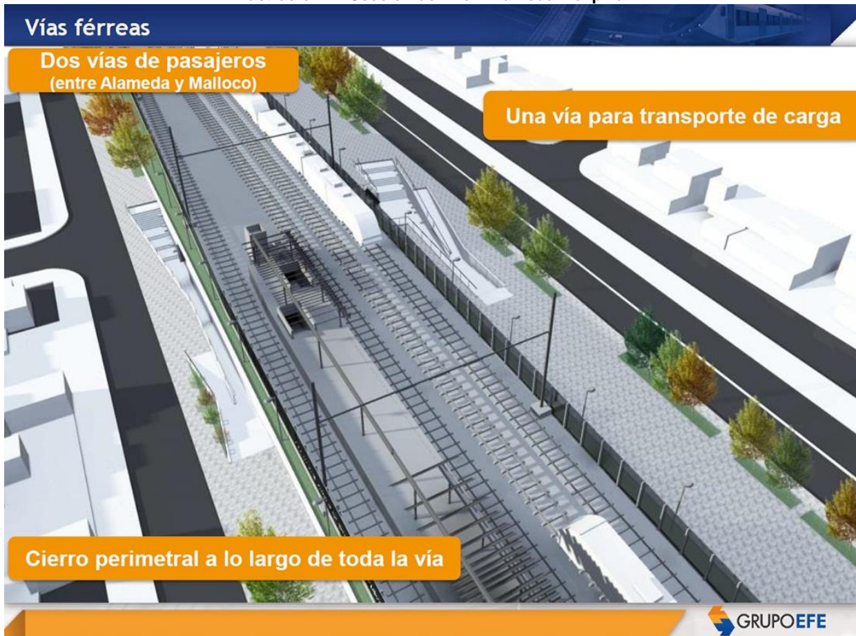
Ilustración 22 Sección del Tren Alameda Melipilla.
