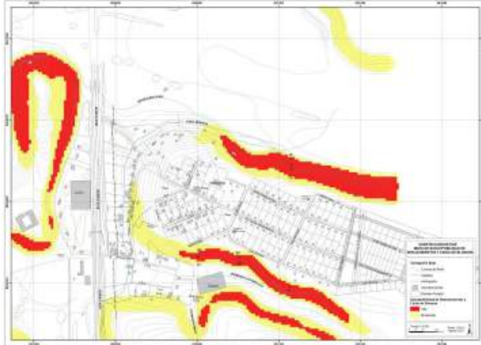
Figura 2-22: Riesgo de caída de rocas y deslizamientos, Localidad de Huentelauquén Sur
