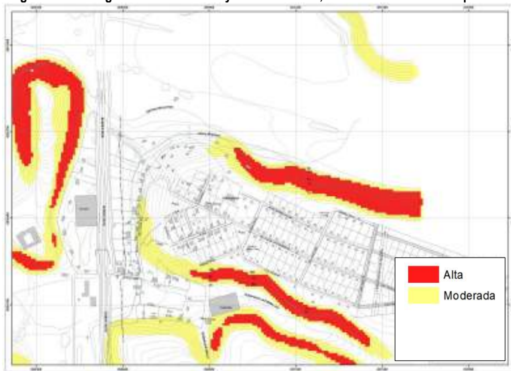
Figura 2-39: Riesgo de caída de rocas y deslizamientos, Localidad de Huentelauquén Sur
