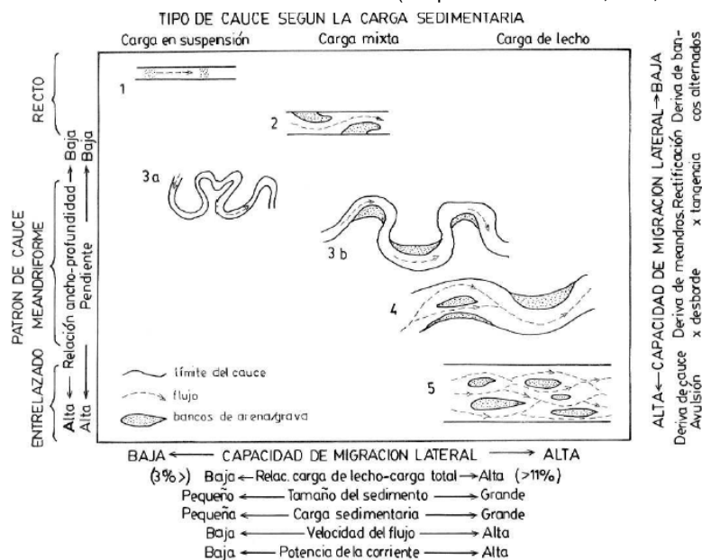
Clasificación de Cauces Aluviales de Schumm (adaptada de Schumm, S.A., 1981)
