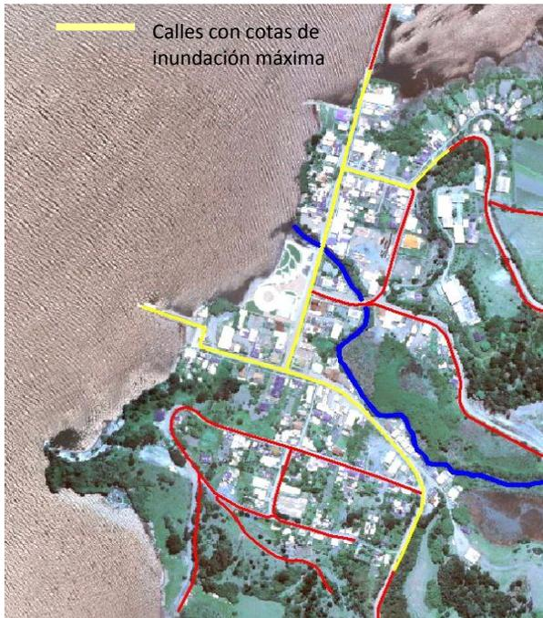
**Imagen Nº88:** Vulnerabilidad de la construcción para inundación y anegamiento, Puerto Domínguez
