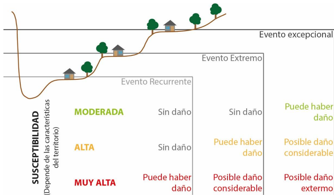
Figura 6-1 Esquema para ejemplificar del daño provocado por eventos de inundación por desborde de cauces con diferente magnitud en zonas que presentan distinto grado de susceptibilidad
