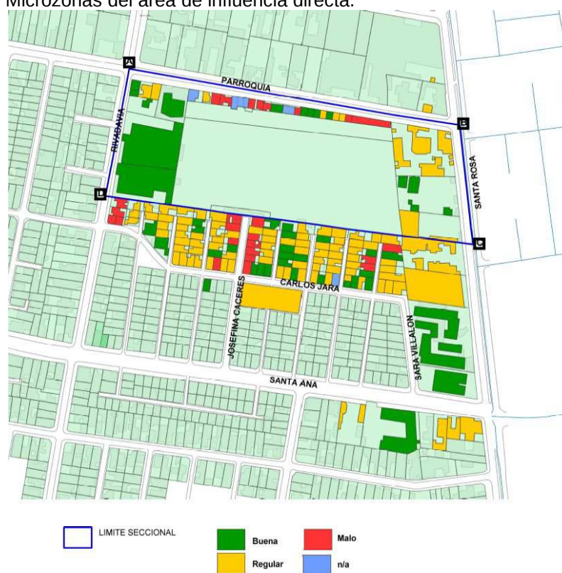
Figura 10: Estado de conservación de las edificaciones en Microzonas del área de influencia directa.
